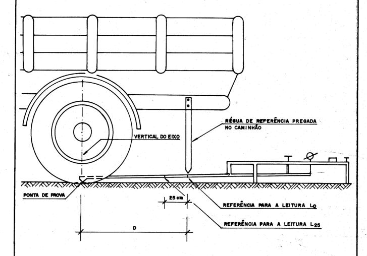
D - DISTÂNCIA MARCADA SOBRE O BRAÇO MAIOR DA VIGA BENKELMAN DE FORMA QUE, AO SE FAZER COINCIDIR A REFERÊNCIA PARA A LEITURA LO COM A PONTA DA RÉ-QUA DE REFERÊNCIA, A PONTA DE PROVA ESTARÁ COLOCADA NA VERTICAL DO EIXO DO CAMINHÃO
