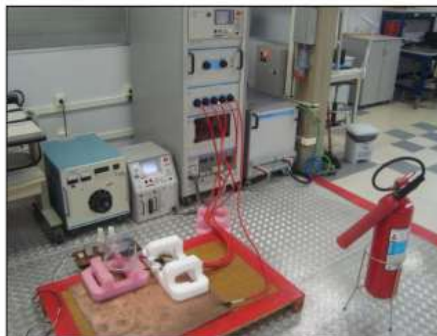
Figura 3 – Aplicação de impulso combinado nos terminais de alimentação do Relé
