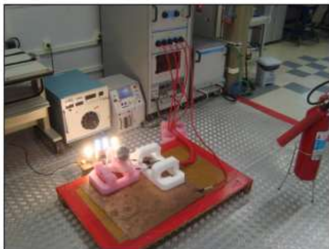
Figura 3 – Aplicação de impulso combinado nos terminais de alimentação do Relé
