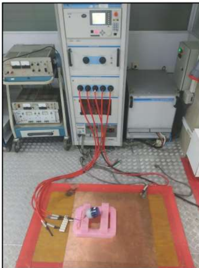
Figura 02 – Aplicação de impulso combinado nos terminais de alimentação
