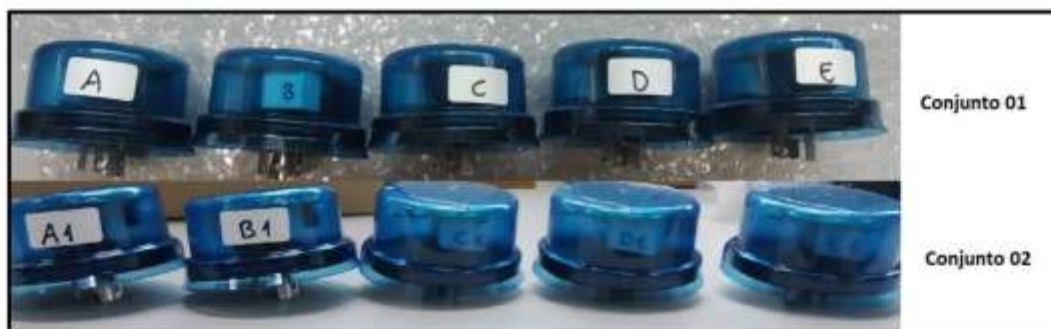
Figura 01 - Relés Fotoelétricos Utilizado nos Ensaios
